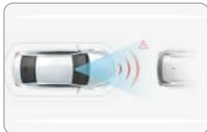
자동긴급제동 시스템(AEB) 위험한 상황을 대비하다
